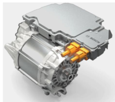
*Slika 8 Modul električnog pogona – Bosch [Izvor](#)*
