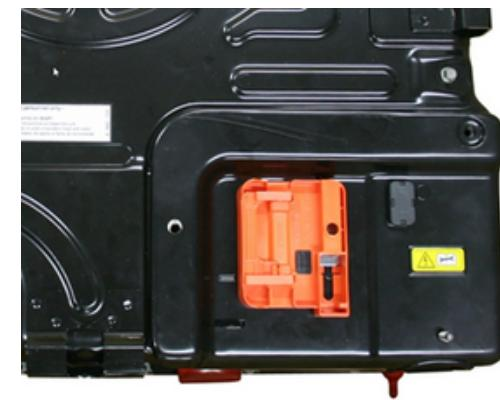
**Logičko zatvaranje;** Prekidanjem signalne linije (blokirajuće petlje) ili linije za napajanje kontaktora, kontaktori se otvaraju i time se visoki napon ponovo isključuje. U hitnim slučajevima, ova linija se može direktno prekinuti radi bezbednosti.
