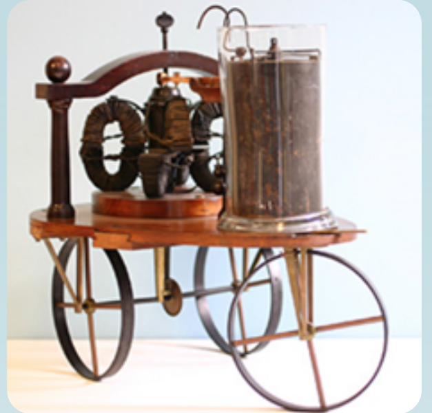
Şekil 2. S. Stratingh tarafından 1835 yılında tasarlanan küçük ölçekli elektrikli araç modeli
