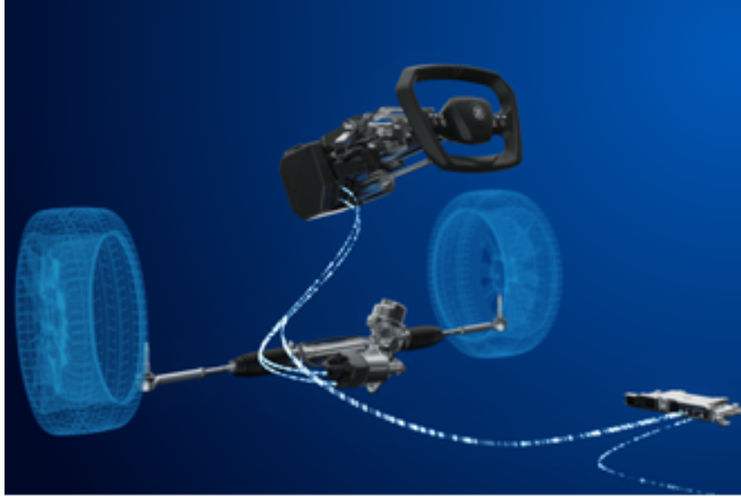
Şekil 13 Telsizle yönlendirme konsepti Kaynağı
